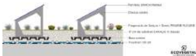
Coupe d'une toiture biosolaire Source : Ecovégétal
