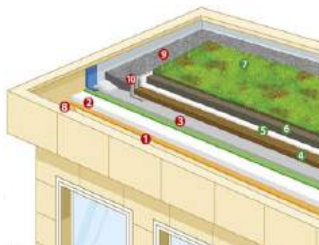
Coupe d'un système de végétalisation type Source : ADIVET, CSFE, SNPPA, UNEP. (2008). Règles professionnelles pour la conception et la réalisation des terrasses et toitures végétalisées. p.13
